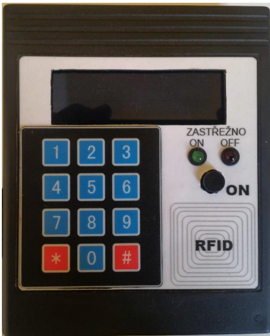
Obr. 12 Ovládací panel domácího zabezpečení
