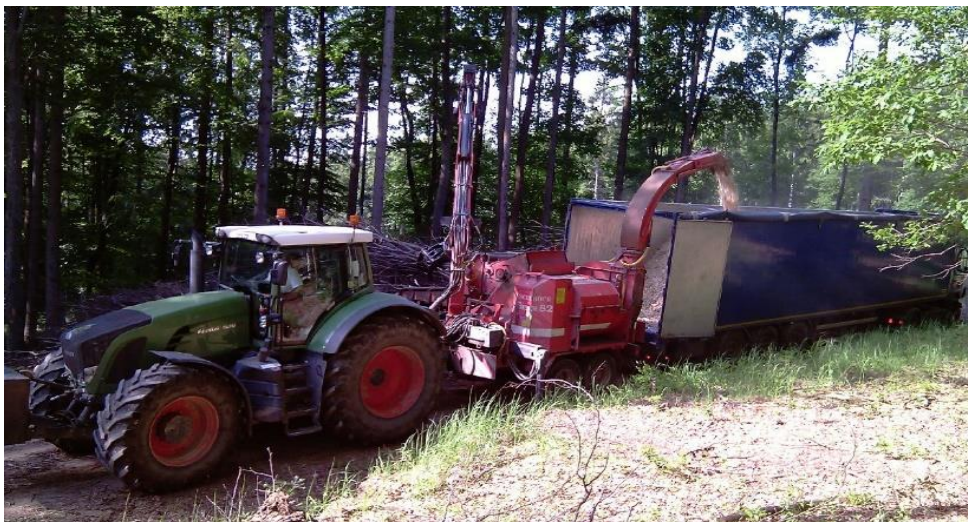
Obrázok 3 Ukážka štiepkovacieho stroja na spracovanie drevenej štiepky
