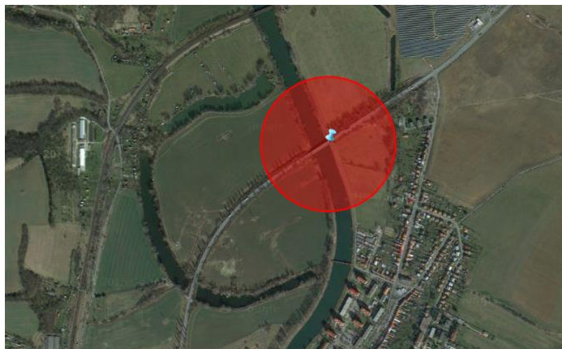
Obrázek 10: Zóna ohrožení únikem – POOL FIRE [32]
