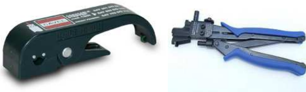
Obr. 4 Odblankovacie a kompresné kliešte [18, 19]
