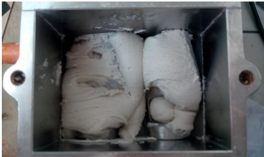
Obrázek 19. Detail hnětiče při míchání směsi.
