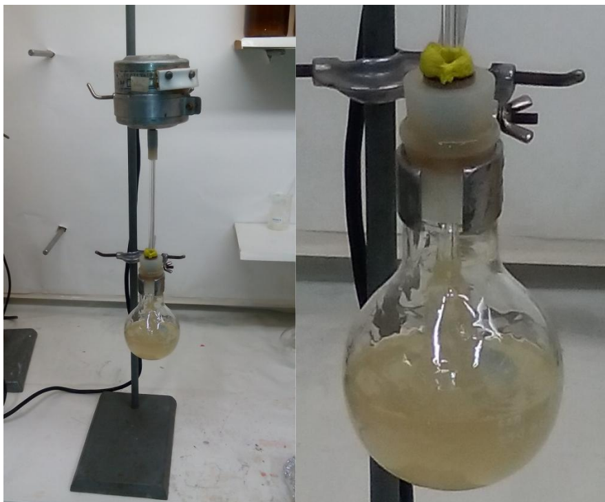
Obrázek 15. Míchání kaučuku a detail baňky při míchání.
