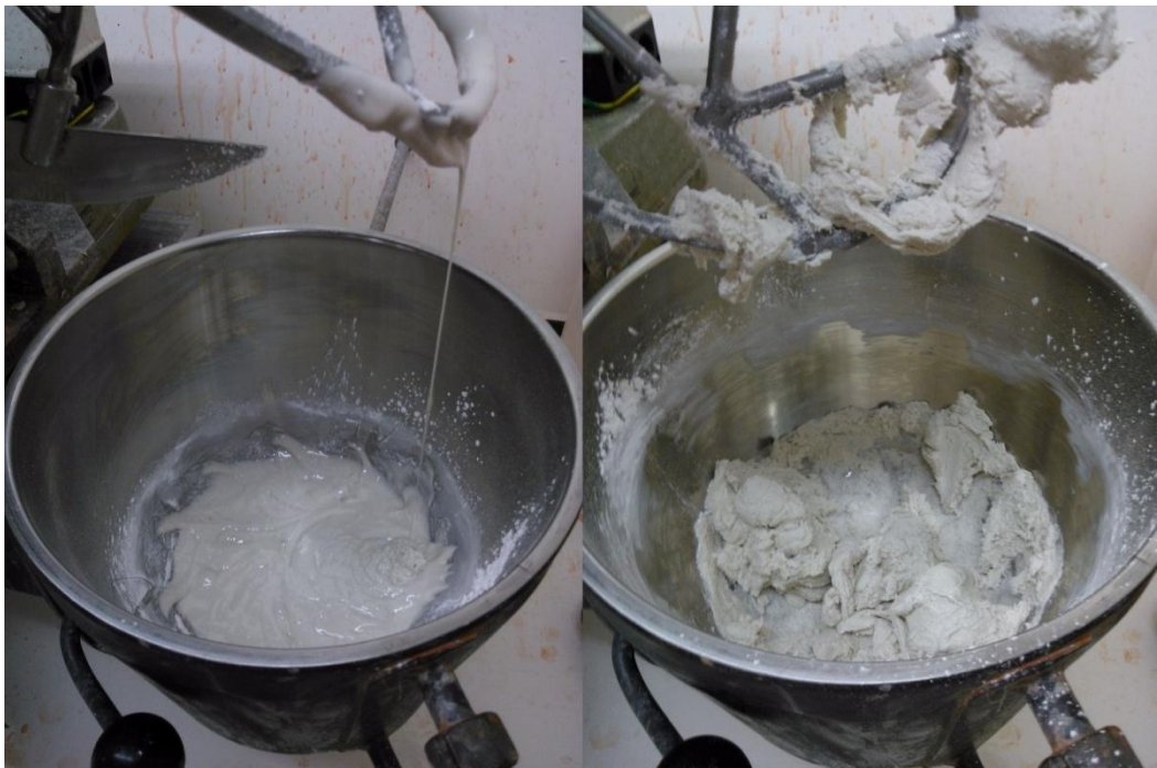
Obrázek 18. Míchání pasty před vmícháním \text{CaCO}_3 (vlevo) a po zamíchání \text{CaCO}_3 .
