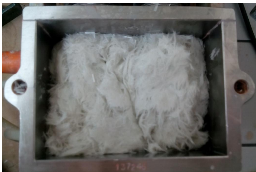
Obrázek 20. Detail BMC směsi po přimíchání skelných vláken.
