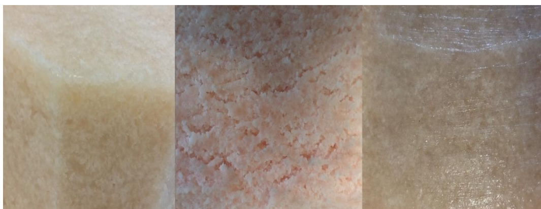
Obrázek 13. Detail použitých kaučuků, zleva HNBR, NANOPRENE B a NBR.
