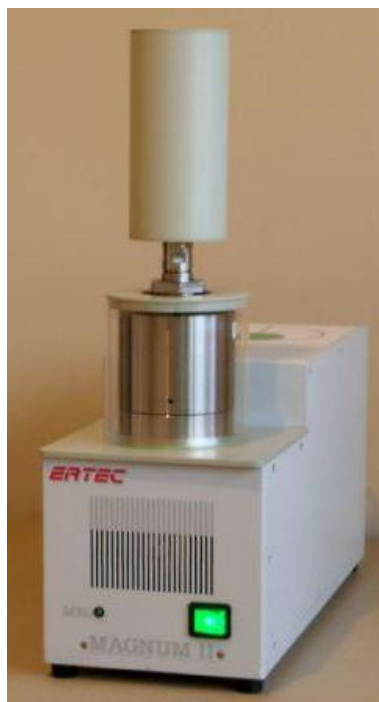
Obrázek 5: Mineralizátor Ertec-Magnum II a jeho řez funkční částí [48 ]
