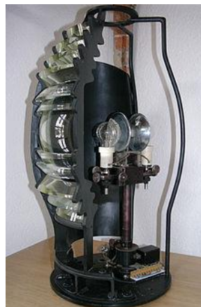
Obr. č. 20 Průřez osvětlovacím tělesem s Fresnelovou čočkou - maják Loschen v německém Bremerhavenu
