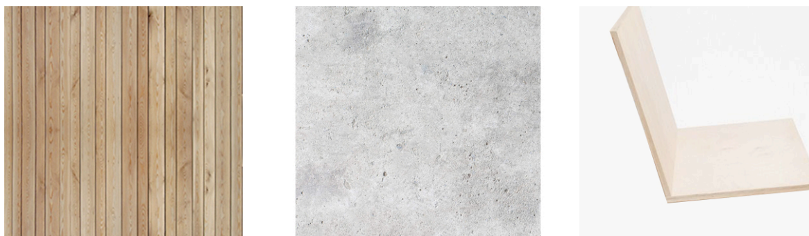
Obr. 55. Materiály letní scény – terasové prkna ze sibiřského modřínu, betonový povrch hlediště a obrubníku jeviště, sedátko z překližky
