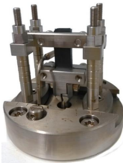
Obr. 3.18 Upnutý vzorek v měřící hlavě přístroje Mettler Toledo DMA 1
