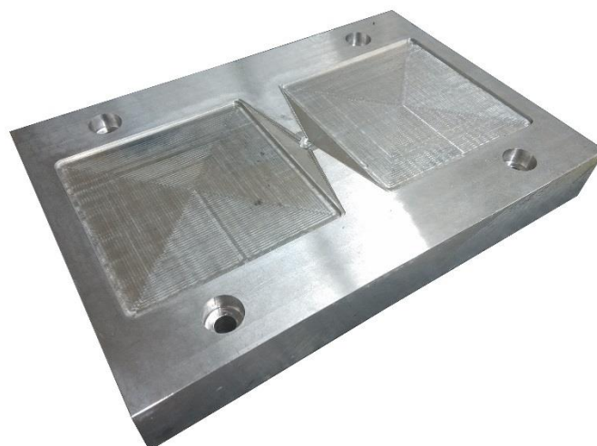
Obr. 3.5. Výměnná tvarová deska pro výrobu plotničky
