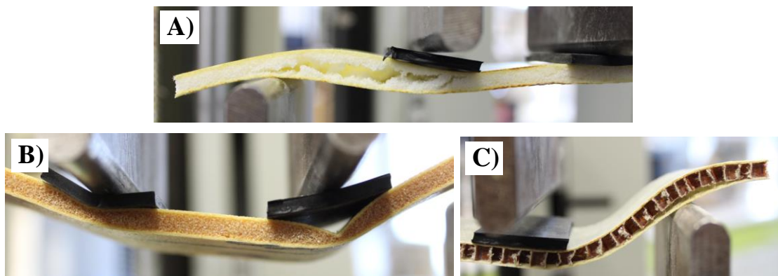
Obr. 6. 19: Ohybové poruchy zakřivených sendvičových konstrukcí s jádrem o tloušťce 5 mm – čtyřbodové uložení těles (4PB)
