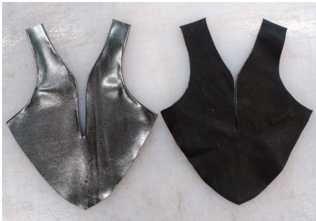
Obr. 47: Připravené dílce - svršek a podšívka
