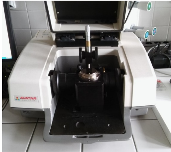
Obr. 23: FTIR spektrometr AVATAR 320.
