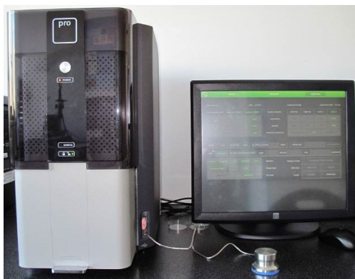
Obr. 17 – Použitý skenovací elektronový mikroskop Phenom G2 Pro.
