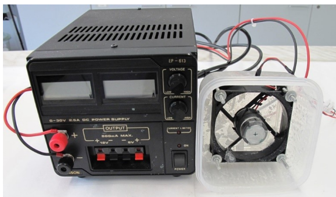
Obr. 16 – Home-made spin-coater – zkonstruovaný pro depozici tenkých polymerních vrstev v laboratoři UFMI, FT, UTB ve Zlíně.
