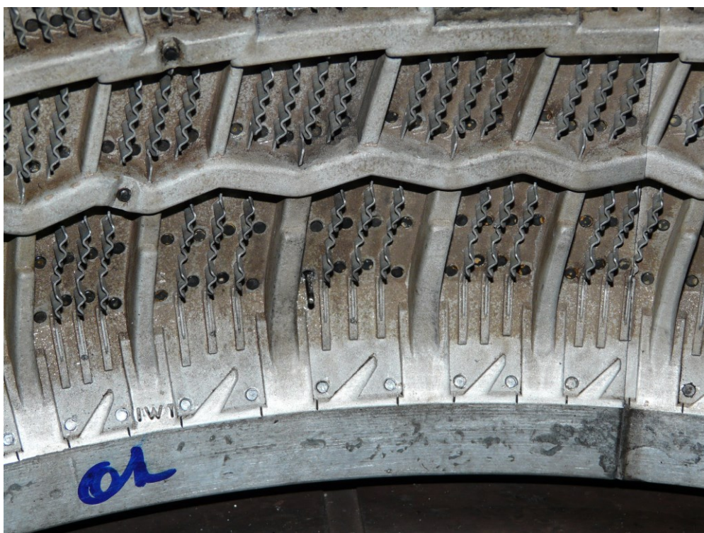
Obr. 50 provrtání dezénové části.
