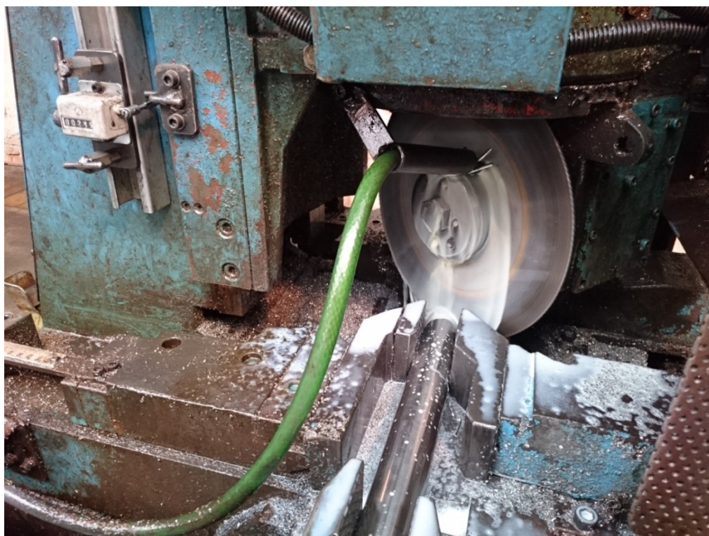
Obr. 14. Nařezání trubek na požadovanou délku.
