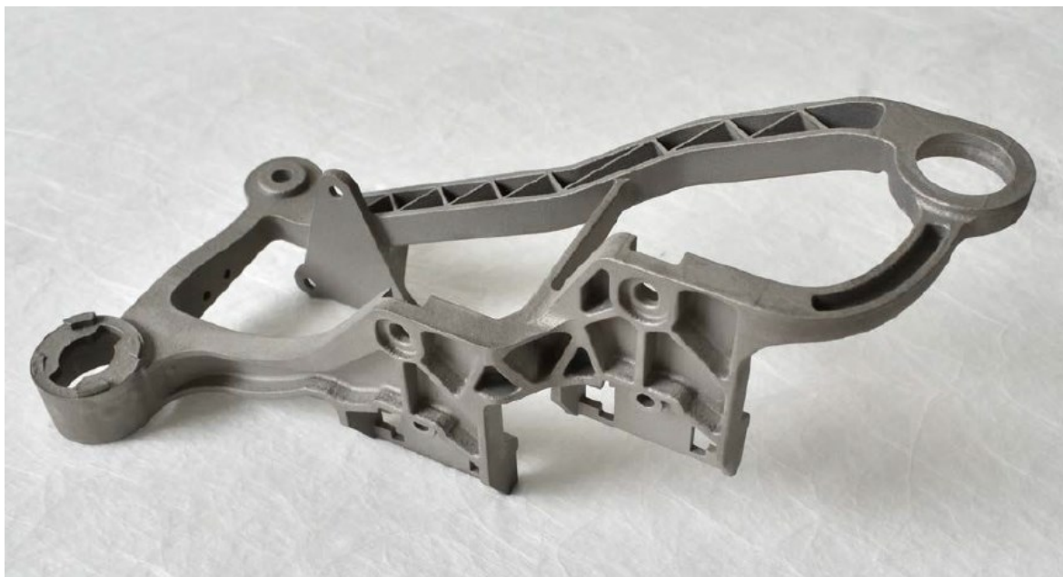
Obr. 51. Ocelový držák LED projektorů – výsledný výtisk
