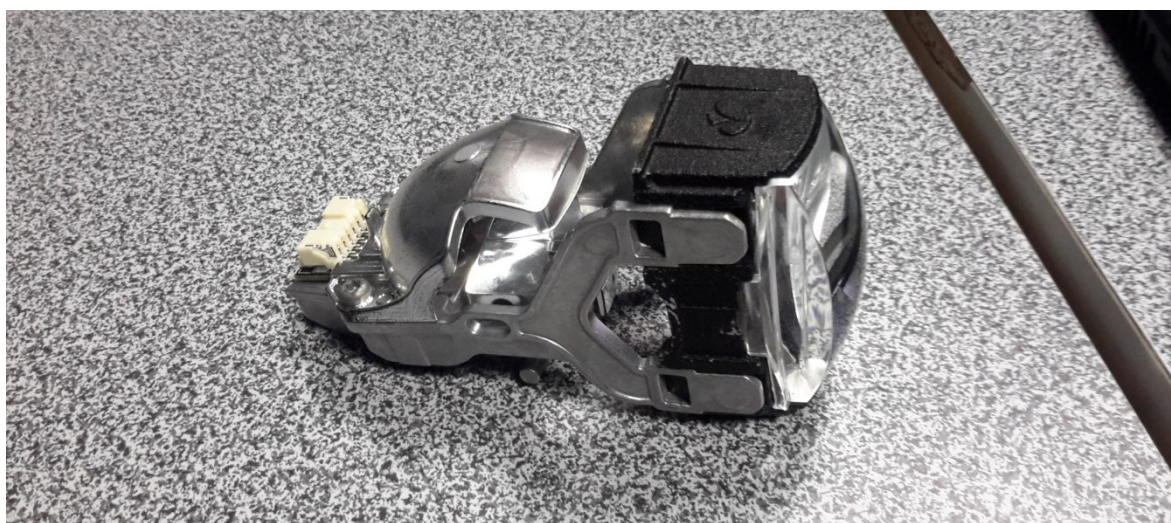
Obr. 43. LED projektor z prototypové produkce Varroc Lightning Systems
