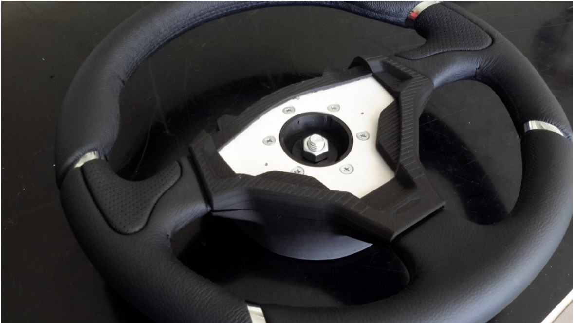
Obr. 65. Složená sestava volantu (bez středového krytu)
