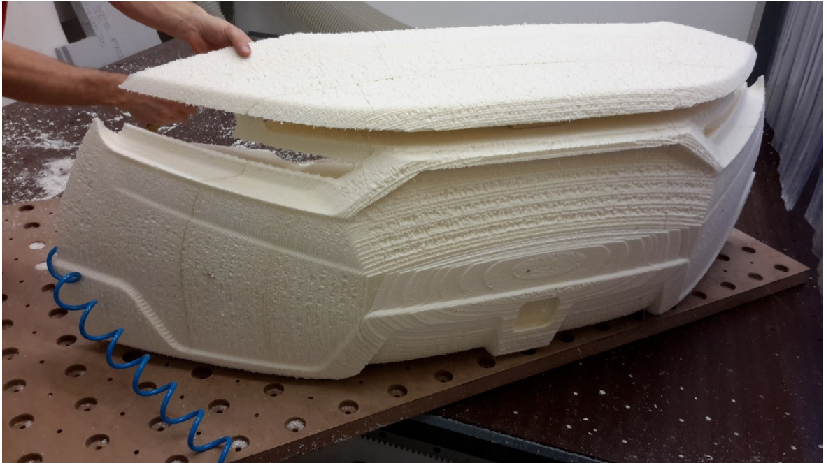
Obr. 81. Zadní díl z EPS po hrubém dofrézování
