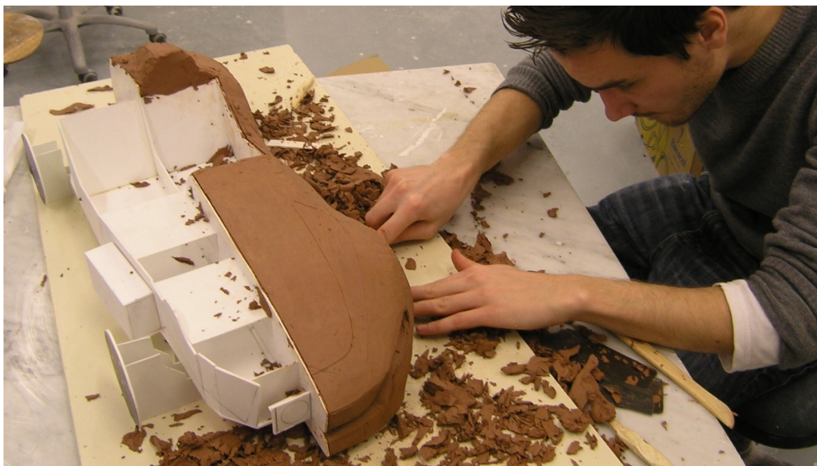
Obr. 36. Výroba clayového modelu v měřítku 1:6
