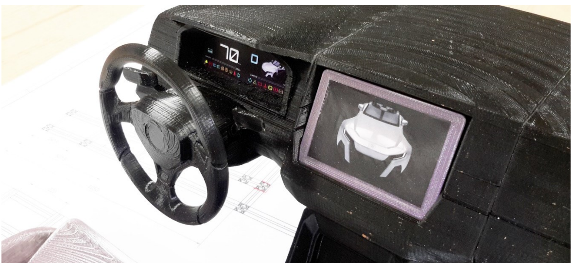
Obr. 67. Stavbě interiéru předcházely zkušební tisk v měřítku 1:4
