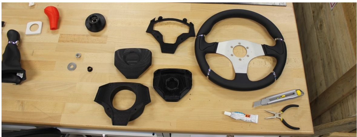
Obr. 64. Rozložená sestava volantu
