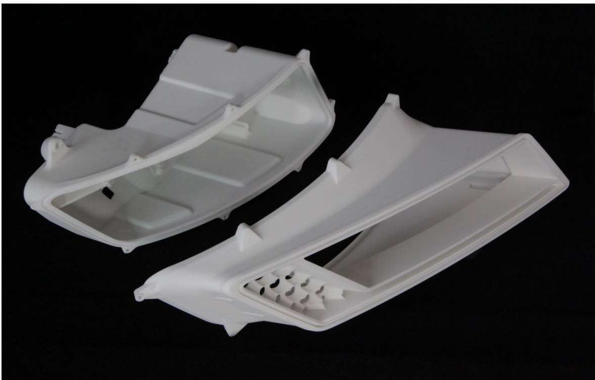
Obr. 47. Přední světlomet - Práškový 3D tisk předního a zadního dílu
