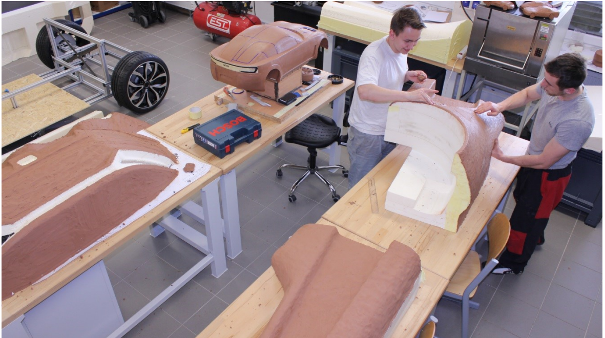
Obr. 85. Nanášení Claye na frézované EPS
