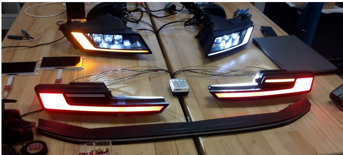
Obr. 53. Zkouška programování předních světlometů a zadních svítilen
