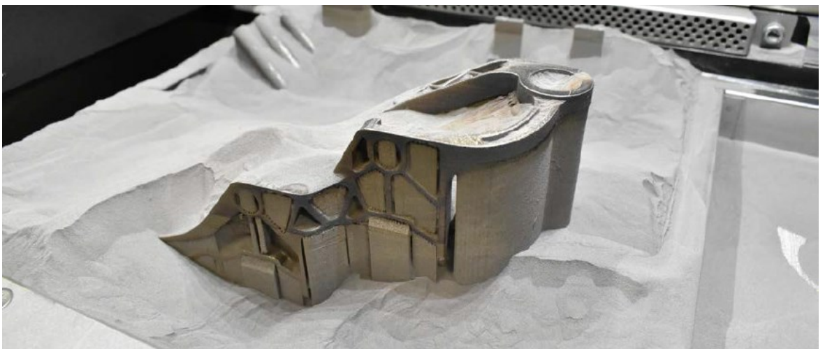
Obr. 50. Práškový tisk vnitřního ocelového rámečku pro přední světlomet
