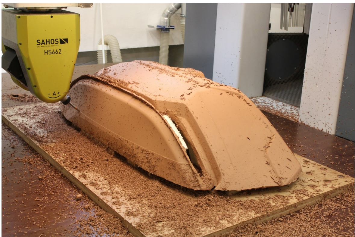
Obr. 90. Frézování claye – zadní díl SCE
