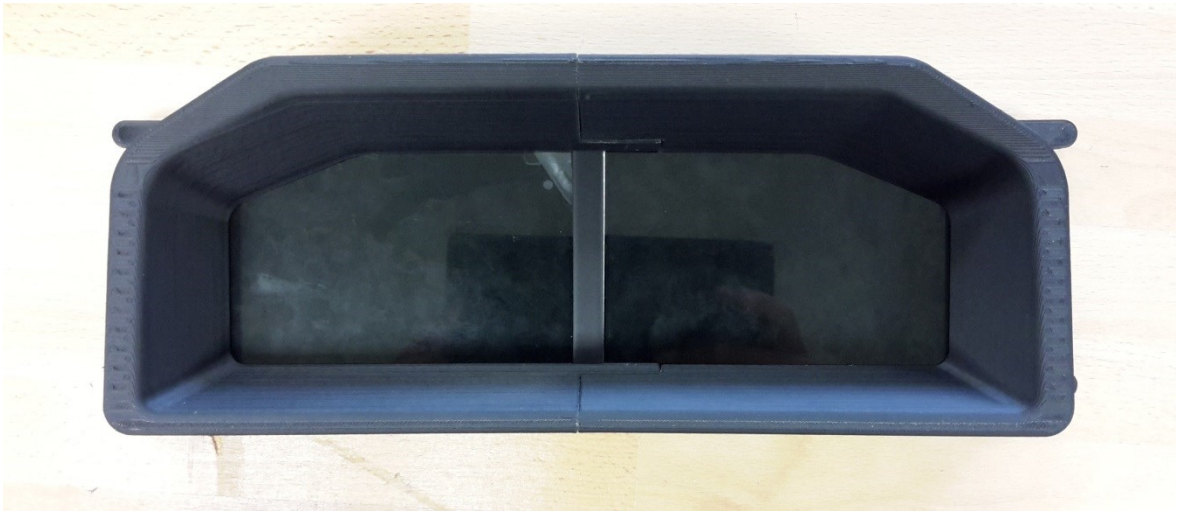
Obr. 70. „Kaplička“ pro LCD displaye umístěné za volantem
