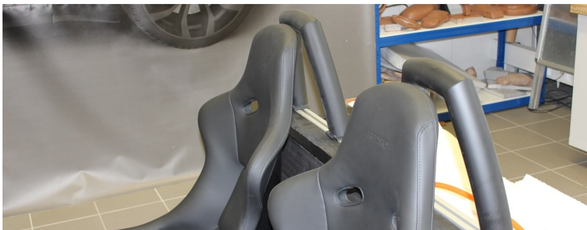
Obr. 74. Bezpečnostní oblouky navrženy s ohledem na dostupnou technologii ohýbání
