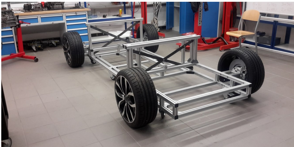
Obr. 61. Zkompletovaný rám makety osazený kompletními koly
