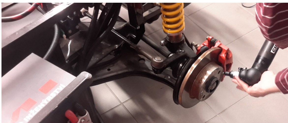
Obr. 42. Přesné měření dosedacích ploch přední nápravy měřicím ramenem
