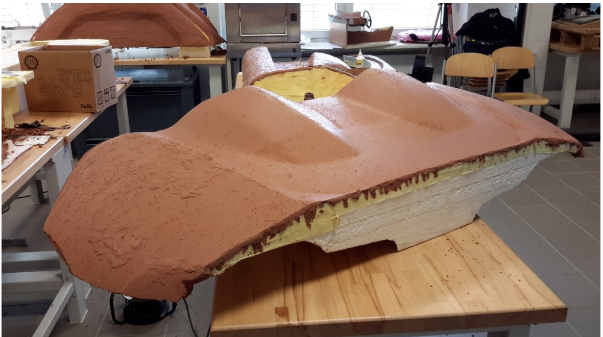
Obr. 86. Naclayovaný díl po korekci ploch před navazujícím frézováním
