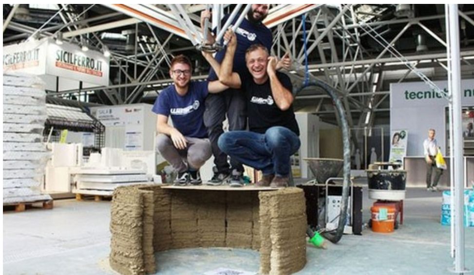
Obr. 73. Zátěžový test na vytlačeném modelu stěn
