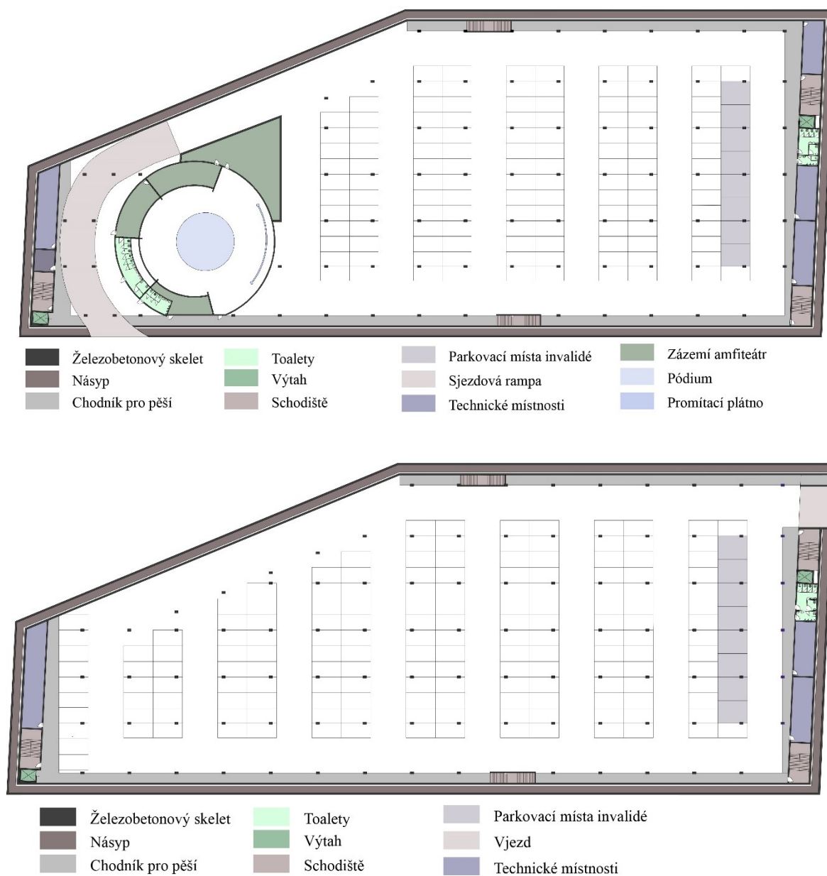
Obr. 59. Schémata 1. a 2. podlaží podzemních garáží
