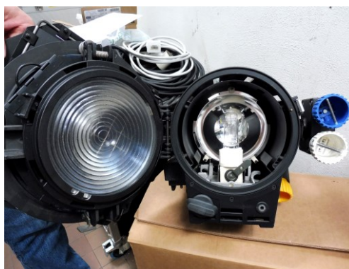
Obr. 43: Světlomet s Fresnelovou čočkou, pohled dovnitř
