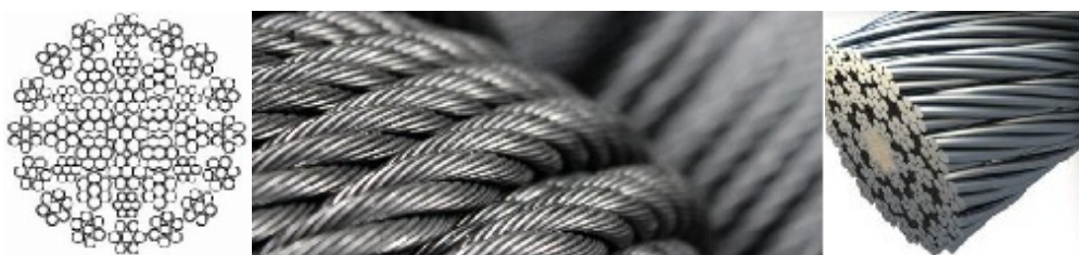
Obr. 53: Řez ocelovým lanem
