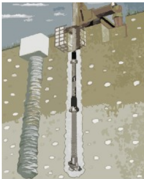
Obr.51: Vsazení mikropiloty do půdy
