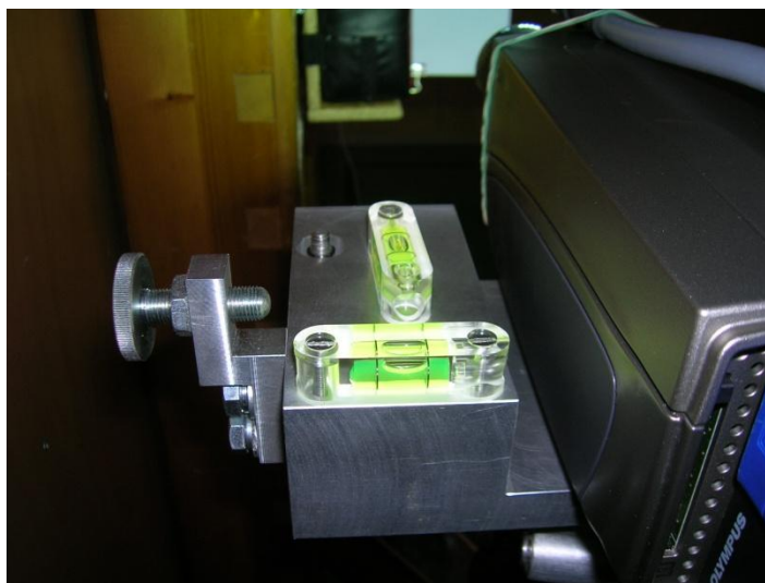
Obr. 40. Libely kontrolující umístění kamery ve vodorovné poloze
