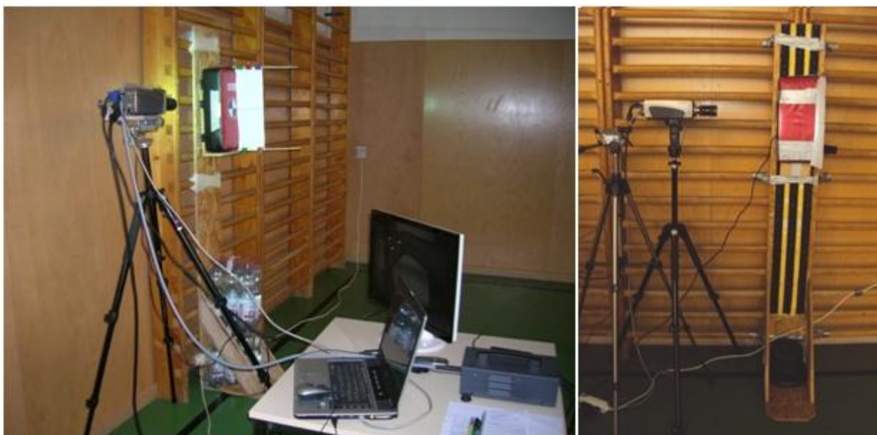
Obr. 39. Umístění vysokorychlostní kamery a měřicího stanoviště dynamických vlastností úderu [46],[47],[49],[50]
