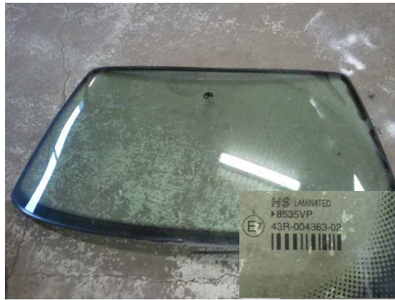
Přední automobilové sklo použité pro mokrou recyklaci včetně jeho označení.
