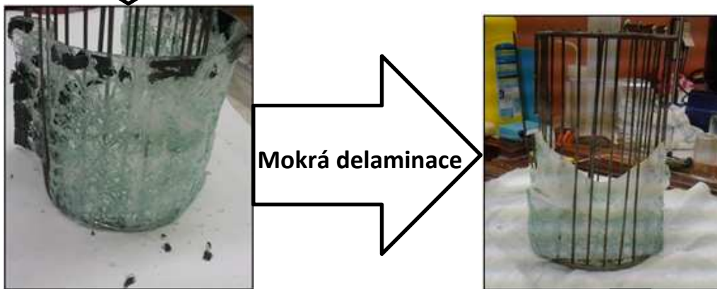
PVB fólie upnutá v rámu před a po delaminaci.
