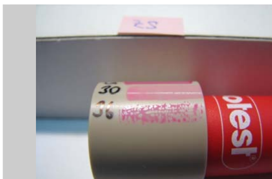
Obr. 7: Povrchové napětí - materiál PEEK - před plazmovou úpravou; < 36 \text{ mN/m}
