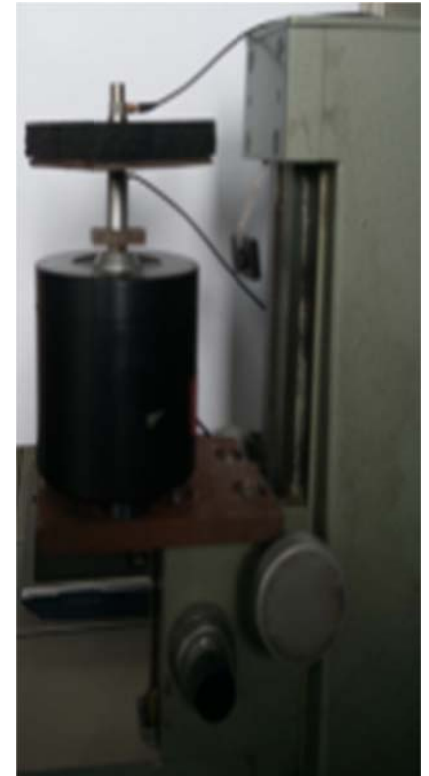
Obrázek 2: Aparatura pro přenosný útlum (řetězec zařízení – vlevo), umístění snímačů na vzorku v pravo
