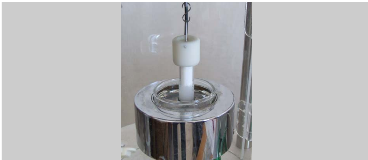
Obr. 2: Měření dynamické vzlínavosti práškového materiálu
