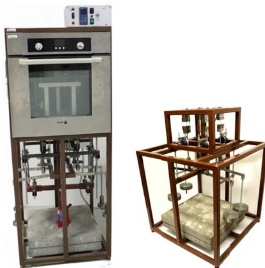
Obrázek 19 : Zařízení pro zkoušení krípového chování při pokojových a při vyšších teplotách
