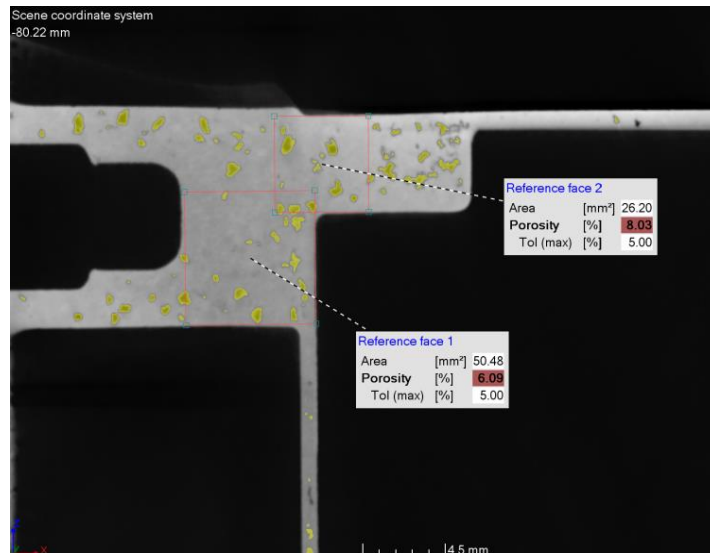
Obrázek 2: Tomografický řez odlitku hliníkové slitiny. Žlutými oblastmi jsou zobrazeny detekované póry této oblasti. Porozita je D10/2.5 dle normy VW50097.
