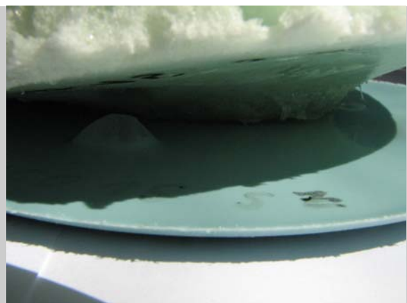
Obr. 5: Vzorek tvořený vrstvami sintrovanými z neupraveného PE materiálu vyplněný PUR pěnou
