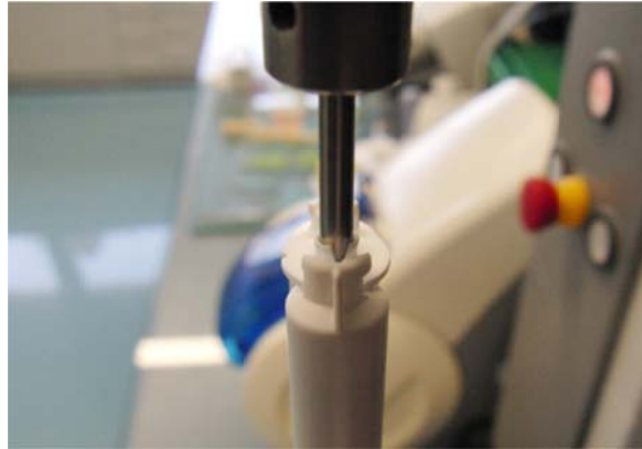
Obr.3: Slabé miesto kartridžu, ktoré by mohlo byť eliminované použitím zmiešavacej trysky.
