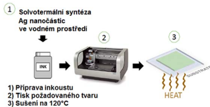
Obr. 1. Proces inkoustového tisku flexibilní antény na PET substrát.
