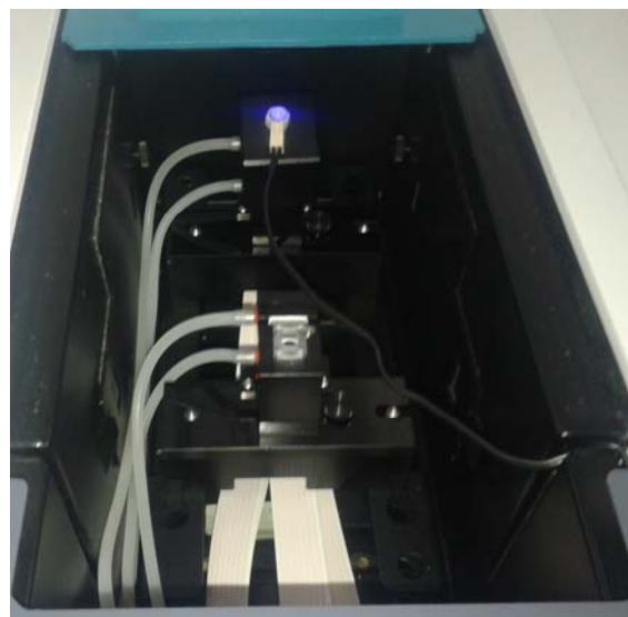
Obrázek 4. Komora s kyvetami a držákem LED v UV-VIS spektrometru Varian Cary 3
