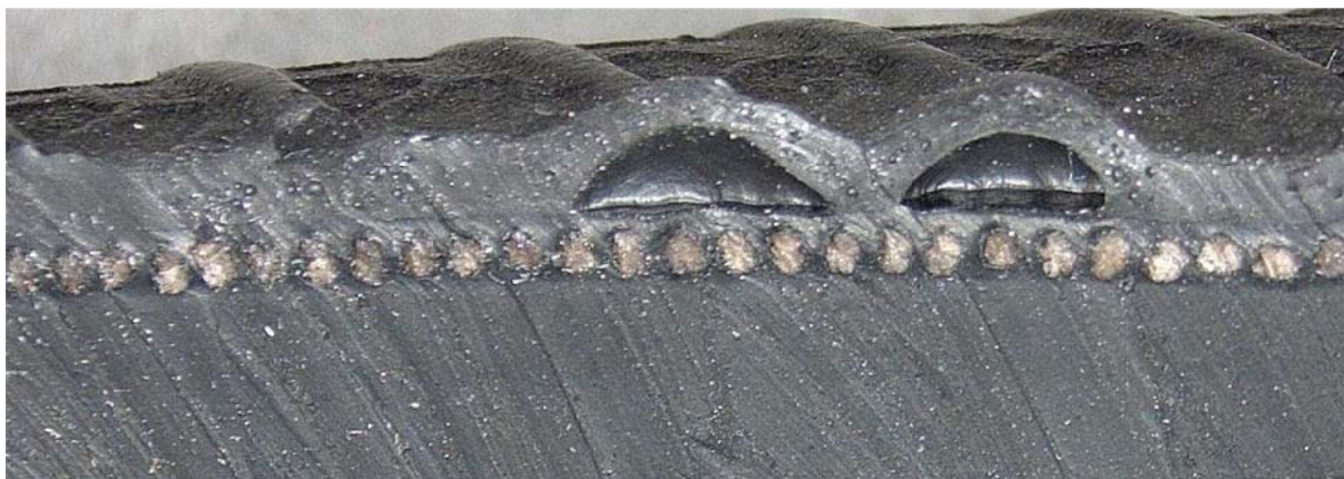
Obr. 1. Vizualizace vad projevující se zvýšenou vlhkostí surovin
