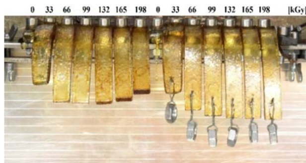
Obrázek 27: Deformace vzorků LDPE při teplotě 220 °C
