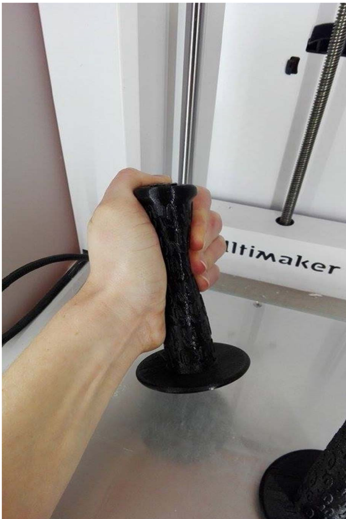
Obr. č. 1 Rukojeť cyklo řídítek z flexibilního TPU materiálu - Flexfill 98A
