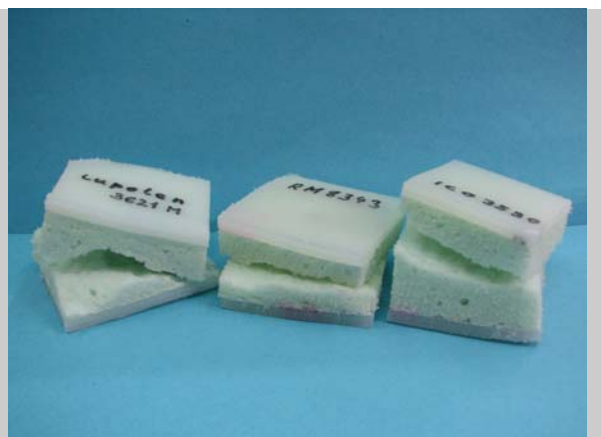
Obr. 6: Vzorky tvořené vnějšími vrstvami z plazmově upraveného PE materiálu vyplněné PUR pěnou po destrukci
