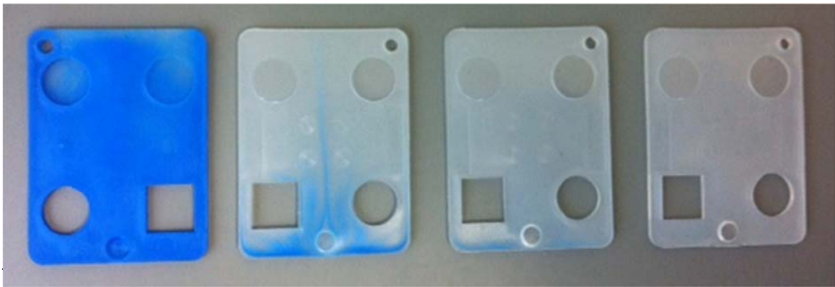
Obr. 5: Promix zmiešavacie trysky ukazujú efektívne inline čistenie
