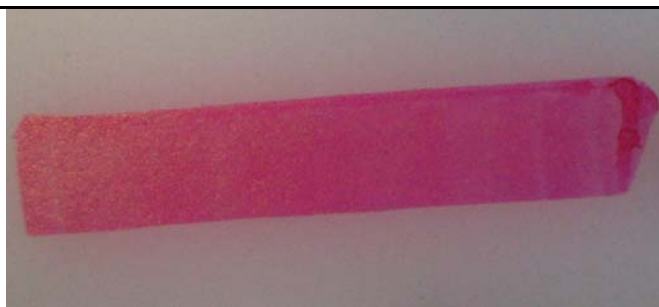
Obr. 4: Zjišťování povrchového napětí na povrchu z plazmově upraveného materiálu
