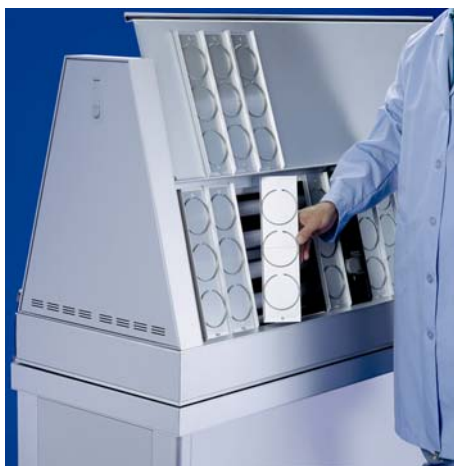
Obr. 7: vkládání vzorků na držácích do stroje QUV
