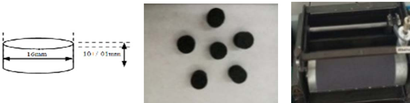
Obrázek 5: vzorky a aparatura pro test oděru-vzdornosti
