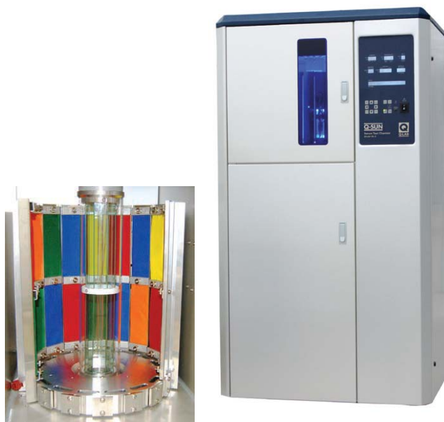
Obr: 2. Rotační Q-SUN XE2, detail uložení vzorků kolem lampy obklopené filtračním systémem
