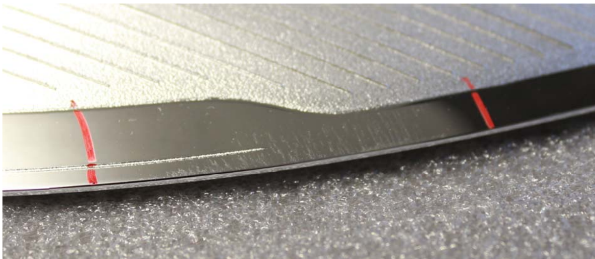
Obr. 1. Povrchová vada (šlíry) na pokoveném výrobku.
