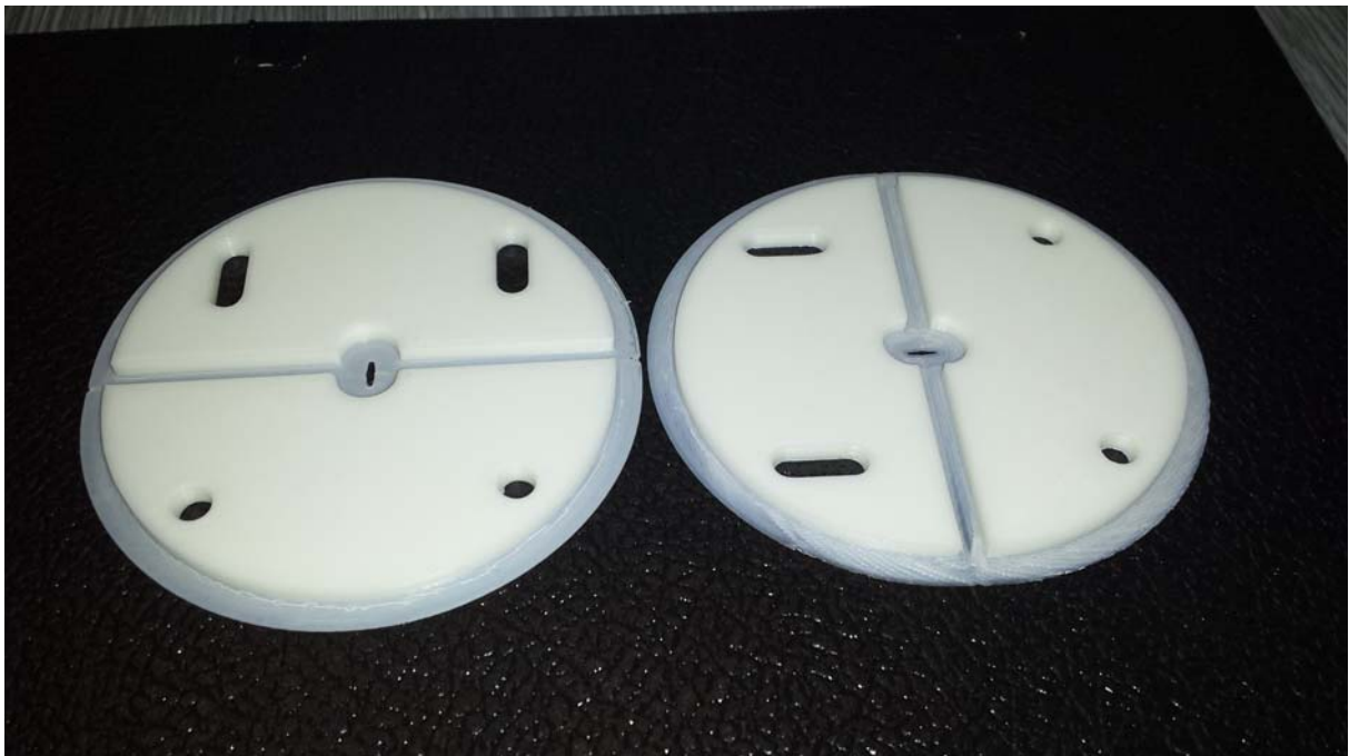
Obr. č. 2 Funkční díly pro extruzní linku - použitý materiál ABS Extrafill
