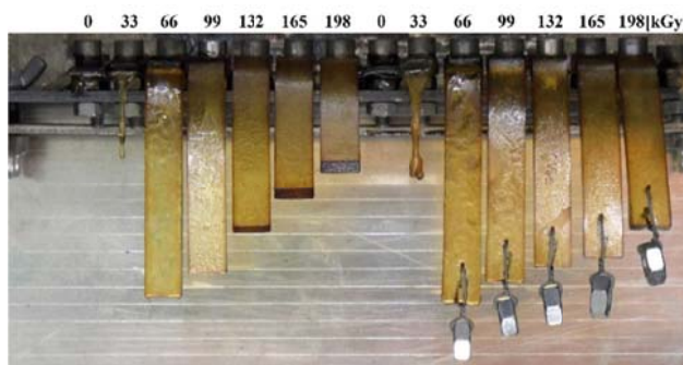
Obrázek 26: Deformace vzorků TPE-PE při teplotě 220 °C
