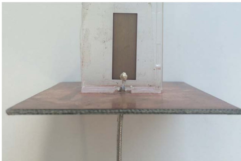
Obr. 4. Fotografie vyrobené antény pomocí inkoustového tisku.
