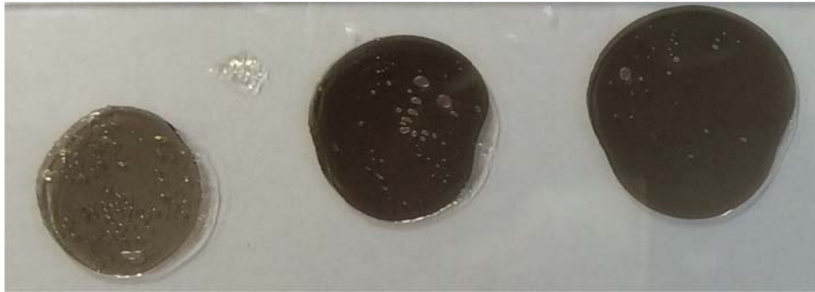
Obr. 9. Zjišťování obsahu vody v materiálu pomocí tzv. sklíčkové metody.
