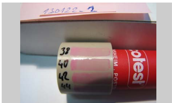
Obr. 8: Povrchové napětí - materiál PEEK - po plazmové úpravě; > 44 \text{ mN/m}
