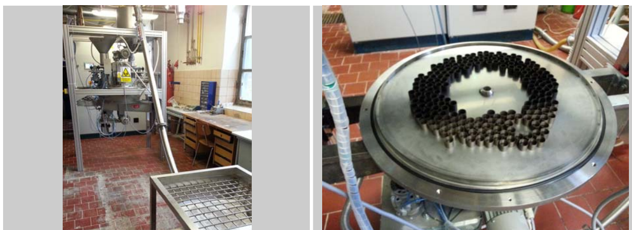
Obr. 10: Zařízení LA 650 pro plazmové povrchové úpravy práškových materiálů i plastových výrobků
