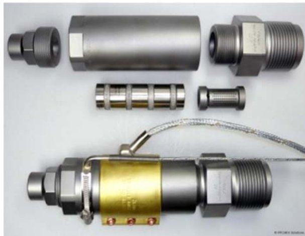
Obr. 1. Časti statického mixéru, filtra a trysky
