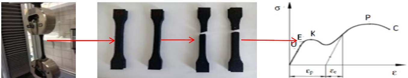
Obrázek 4: Vzorek v čelistech před zkouškou (vlevo), vzorky před a po zkoušce (uprostřed), obecná křivka tahové zkoušky (vpravo)
