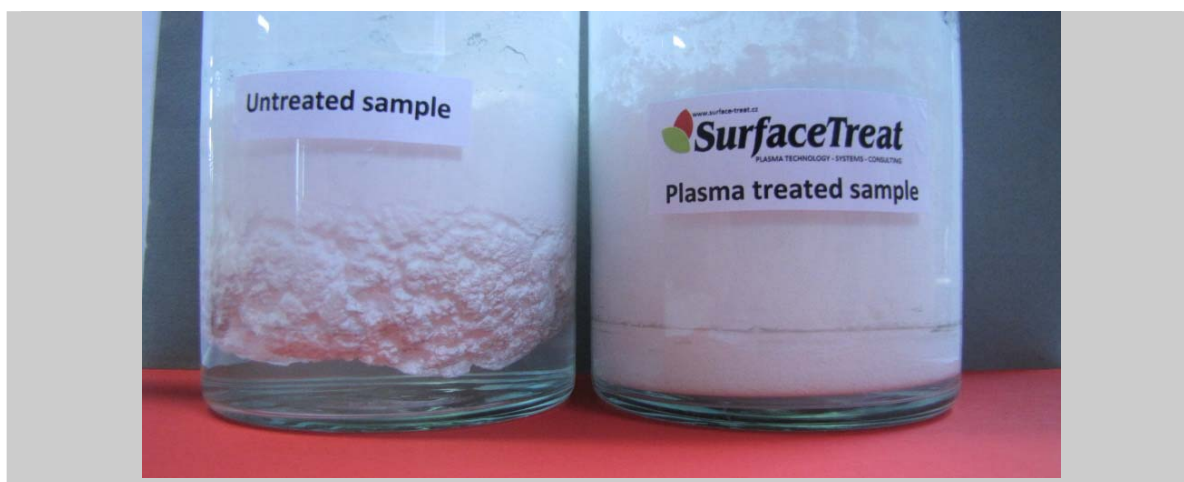
Obr. 1: Porovnání smáčivosti neupraveného a plazmově upraveného práškového materiálu po rozmíchání ve vodě
