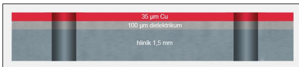
Obr. 4.6: Složení IMS materiálu a velikosti jednotlivých vrstev [23].
