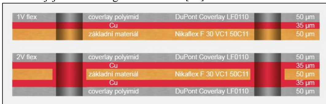
Obr. 4.7: Grafické znázornění řezu DPS typu flex [23].
