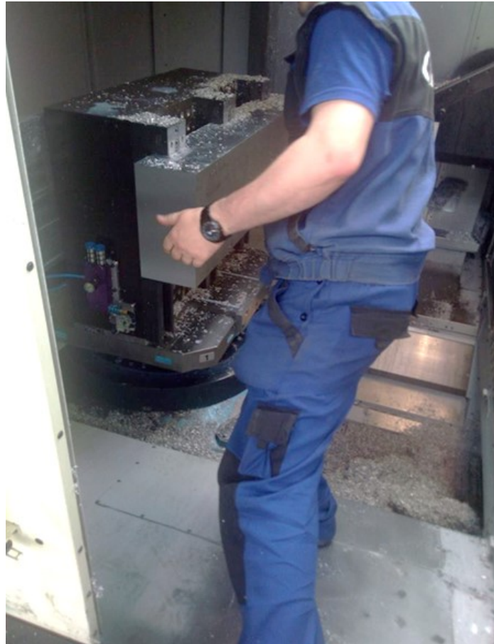
Obr. 12: Pozice operátora při měření otvorů během obrábění (interní zdroj)
