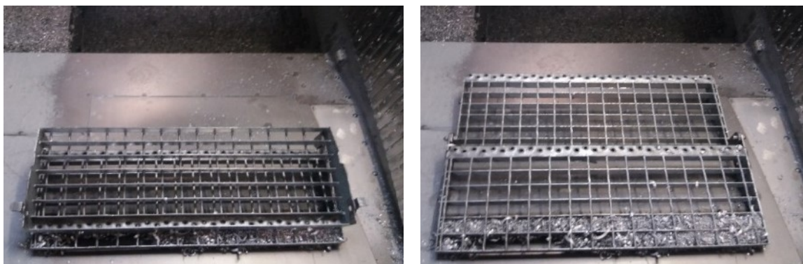
Obr. 24: Instalované bezpečnostní stupátko - složený a rozložený stav (interní zdroj)
