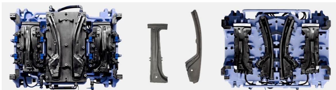
Obrázek 6: Nástroj horkého tváření, který lisuje 4 díly najednou - A a B sloupky (Weba, © 2018)
