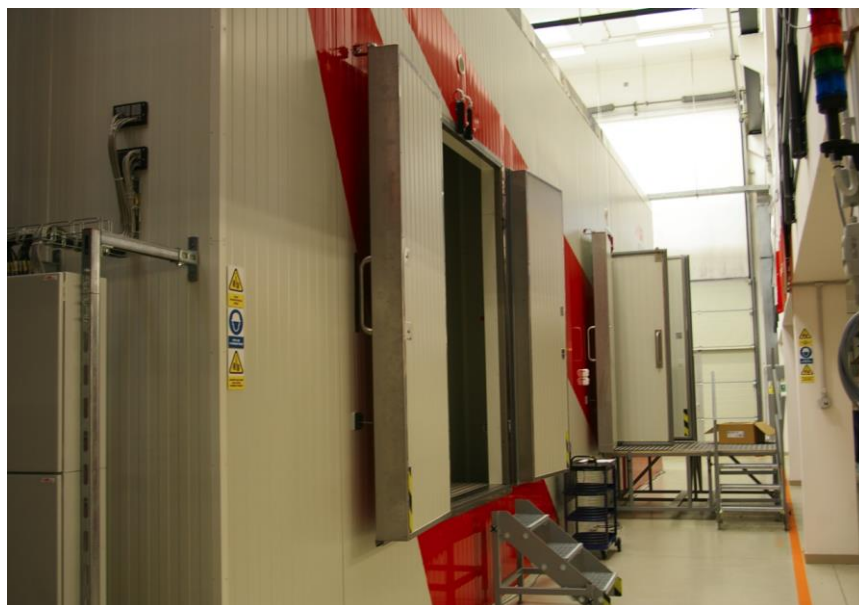
Obr. 5 Kalorimetrická kompenzovaná komora - pohled z vnější strany
