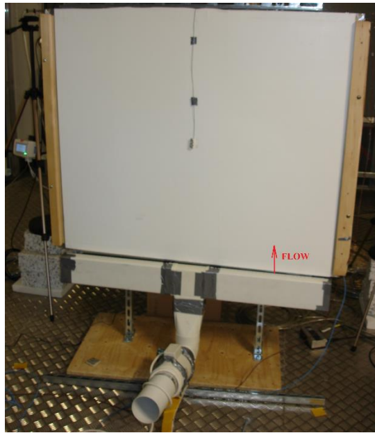
Obr. 28 Použití nucené konvekce (difuzoru) k ochlazení PCM desky
