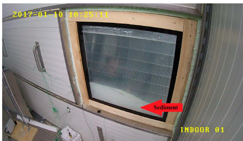
Obr. 18 Fotografie uložení skla v dělicí příčce KK včetně sedimentu
