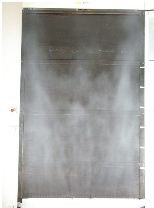
Obr. 25 Kouřová zkouška rozložení vzduchu z reálného difuzoru
