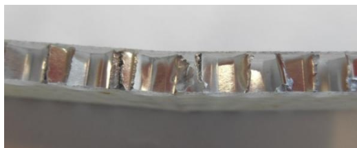
Obr. 7.2 Trvalé prohnutí vzorku (bAlSv)
