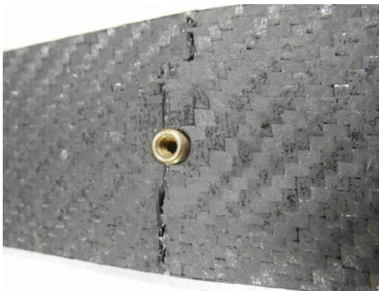
Obr. 7.16 Prasklina potahu tečující insert (sAlUy)
