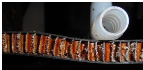
Obr. 7.15 Dlouhá prasklina jádra (smyk jádra), z počátku rovnoběžná s potahem (bNoUv)
