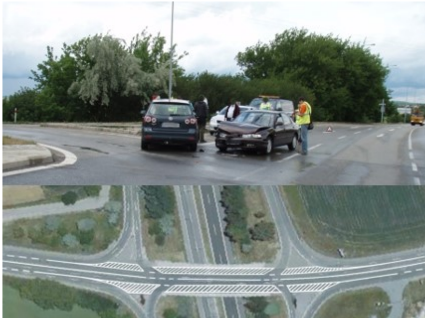
Obr. 13 Nepřehledná křižovatka ulic Ostravská a Holzova v Brně s následným návrhem úpravy
