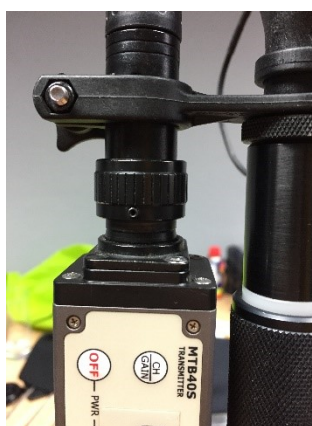
Obrázek 17 - Mikrofonní zásuvný vysílač Wisycom MTB40S zašroubovaný k XLR konektoru
