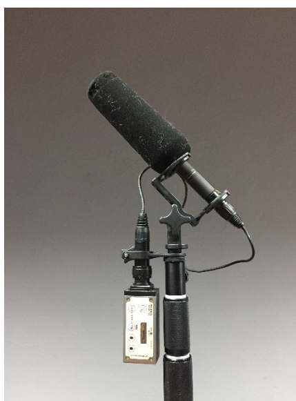
Obrázek 16 – Mikrofonní zásuvný vysílač Wisycom MTB40S zašroubovaný k XLR konektoru
