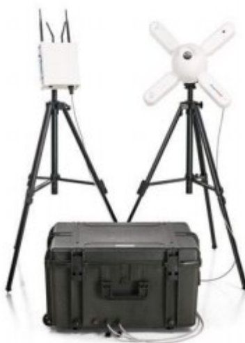
Obr. 34: Navržený přenosný systém detekce dronů [51]
