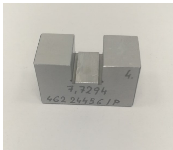
Obrázek 42 Pomůcka ke kalibraci/nulování měřidla
