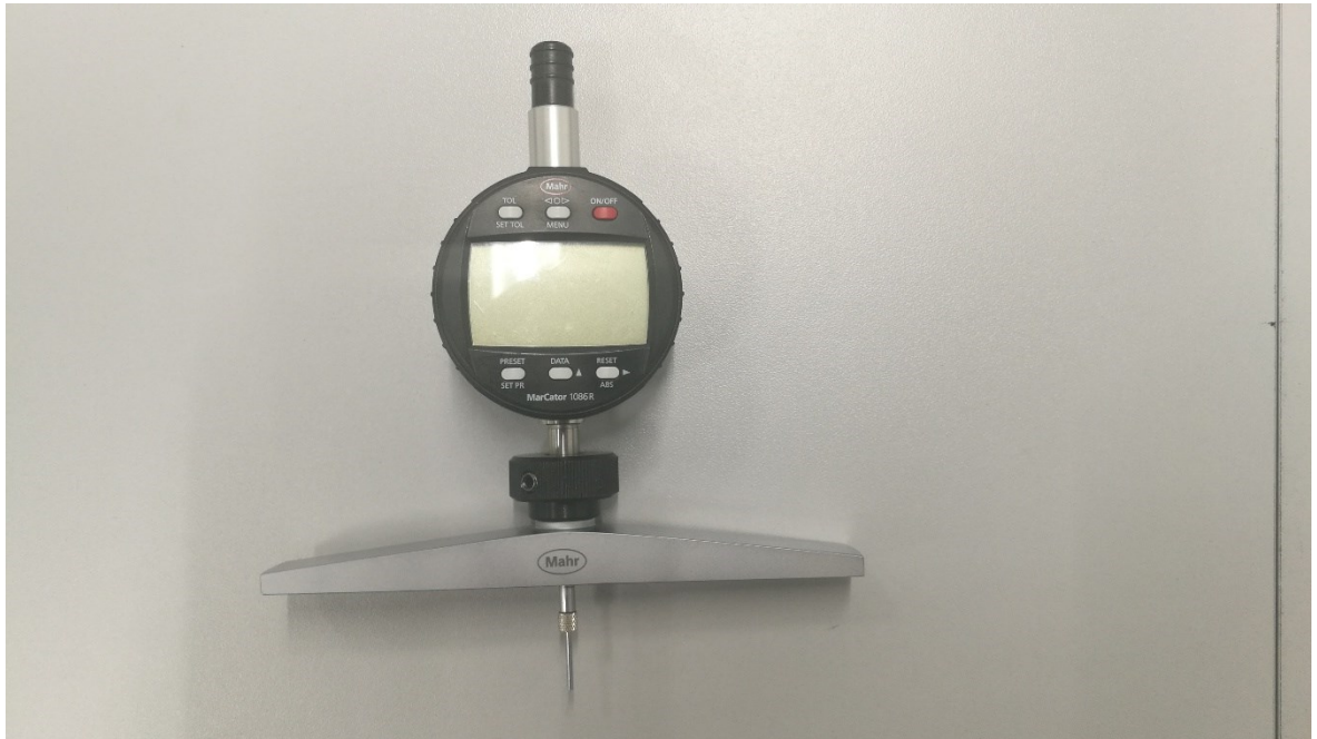
Obrázek 44 Nové měřidlo pro druhé nápravné opatření
