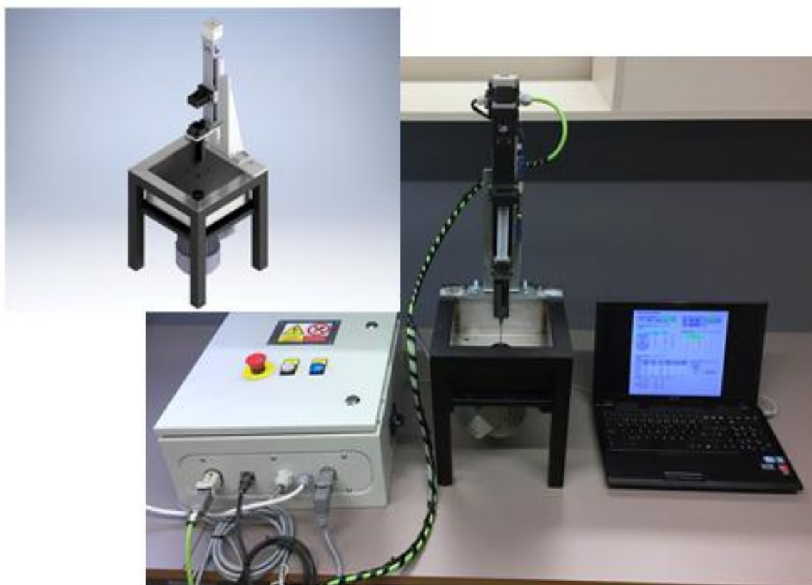
Obr. 14 - Zařízení pro časově sekvenované dávkování směsných rozpouštědel na rotující povrch (TSSC). Zařízení vyvinuto na UFMI, UTB ve Zlíně. 39
