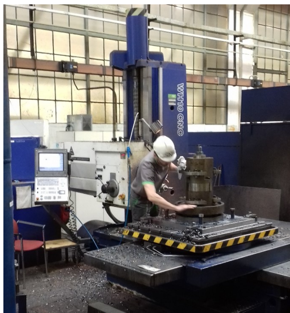
Obr. 17. Čištění pracovního stolu
