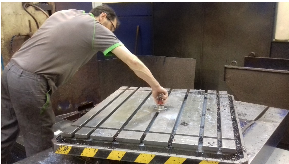
Obr. 18. Usazování středícího přípravku
