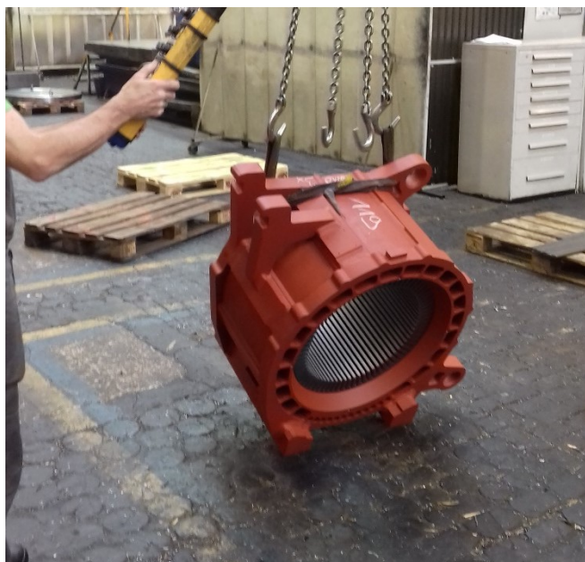
Obr. 13. Změna polohy obrobku pomocí nosného lana
