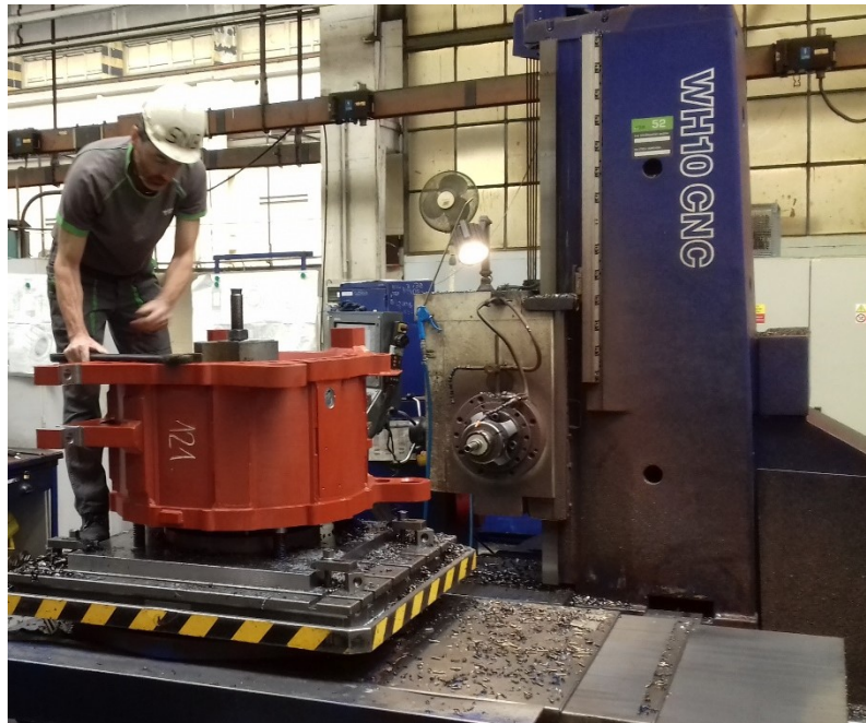
Obr. 16. Utahování obrobku na přípravku
