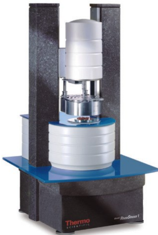
Obr. 7 – Rotační reometr Thermo Scientific HAAKE RheoStress 1
