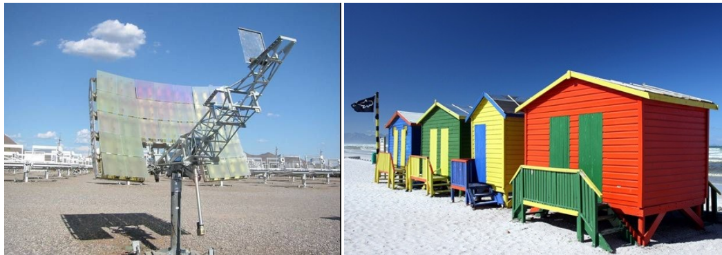
Obr.7: Ultra-Accelerated Exposure Testing (vlevo) a testování nátěrů (vpravo) [33]
