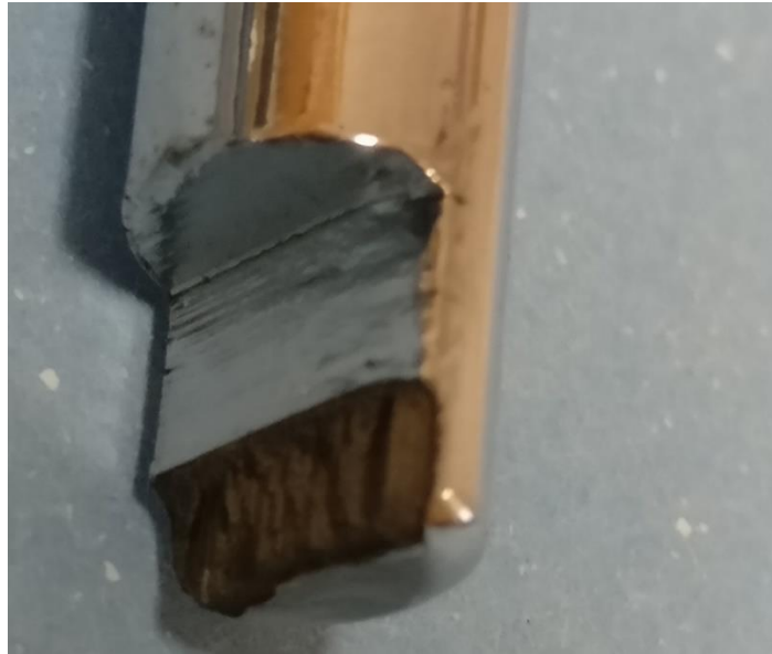
Obr. 18. Detail bodu zlomu vzorku č. 2
