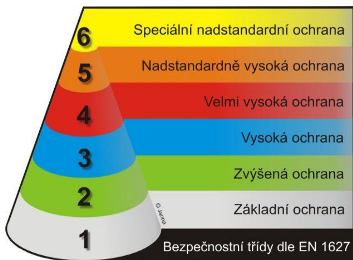
Obr. 1. Stupně bezpečnostní třídy dle normy EN 1627 [16]
