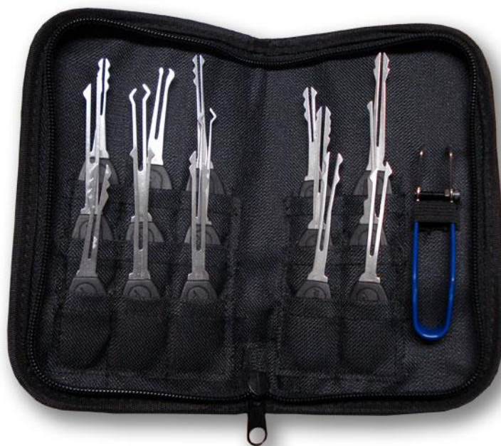
Obr. 7. Soupravy planžet pro nedestruktivní metodu překonání zámkových systémů [13]
