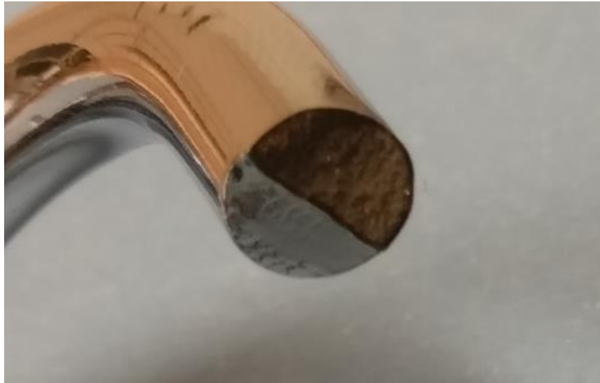
Obr. 22. Detail bodu zlomu vzorku č. 7
