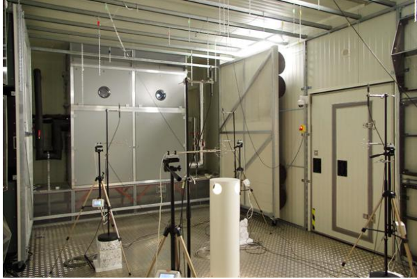
Obr. 4.5. Pohled do outdoor části komory při kalibraci přičky
