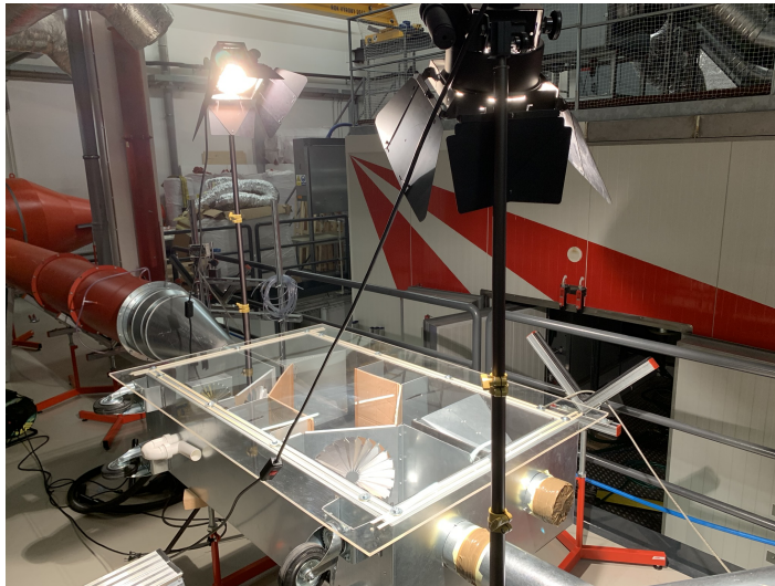
Obr. 5.15. Konfigurace aparatury při vizualizaci proudění vzduchu za pomoci héliových bublin
