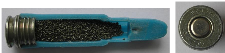
Obr. 1 Plastový redukováný puškový náboj ráže 7,62 x 51. Vlevo – podélný řez nábojem, vpravo – dnová část náboje se značením (šablonováním) náboje
