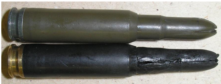
Obr. 11 Vystřelené puškové plastové cvičné náboje. Nahore – tmavě zelený náboj vystřelený z balistické hlavně, dole – černý náboj vystřelený z pušky Mauser „Erfurt“, model 98
