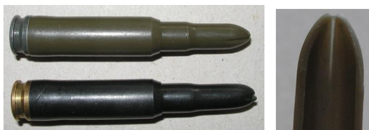
Obr. 2 Plastové puškové cvičné náboje ráže 7,62 x 51. Vlevo – celkový pohled na náboje, vpravo – je vidět zeslabení (zářez) předního ogiválu náboje
