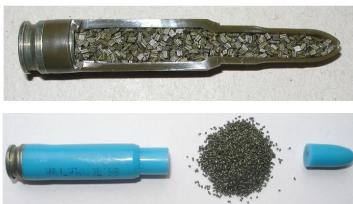
Obr. 3 Puškové plastové náboje ráže 7,62 x 51. Nahoře – cvičný puškový náboj, dole - redukovaný náboj s oddělenou plastovou střelou a vysypaným bezdýmým prachem
