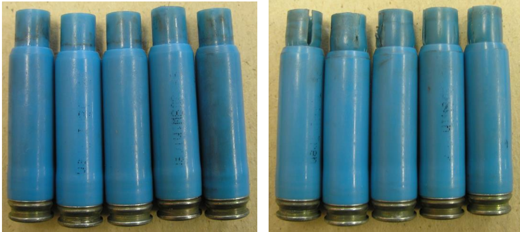
Obr. 6 Porovnání stavu plastových nábojnic redukovaného puškového náboje ráže 7,62 x 51, série DAG 96H0629 po výstřelu. Vlevo – nábojnice vystřelené z balistické hlavně, vpravo – nábojnice vystřelené z pušky Mauser „Erfurt“, model 98
