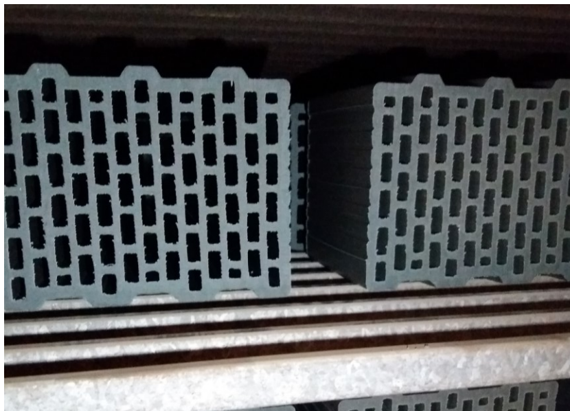
Obrázek 17 Sušení výlisku PB300B v komorové sušárně (vlastní zpracování)
