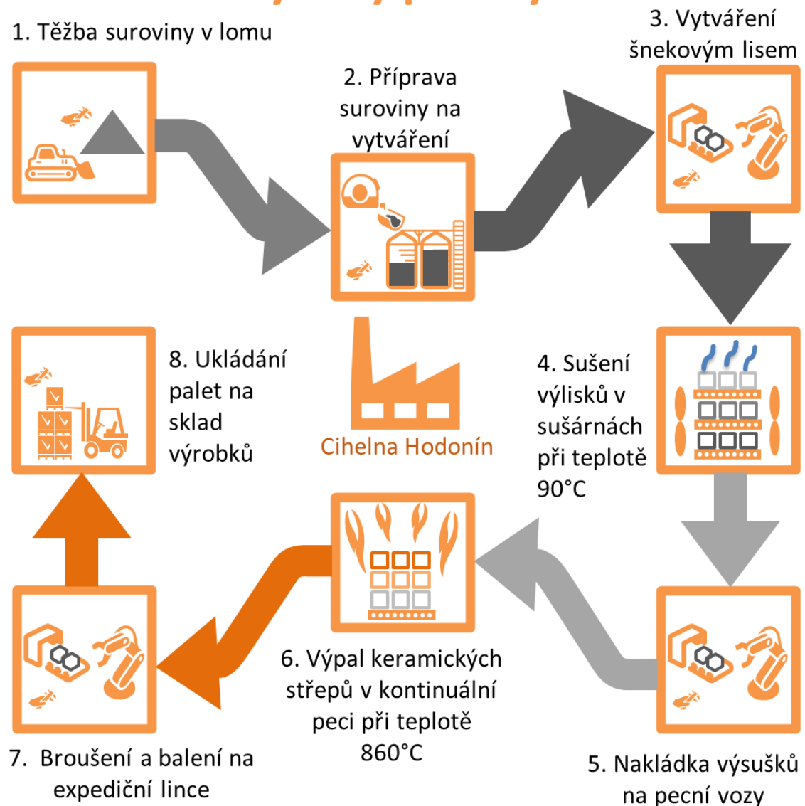
Obrázek 14 Proces výroby znázorněný v Sankeyově diagramu (vlastní zpracování)
