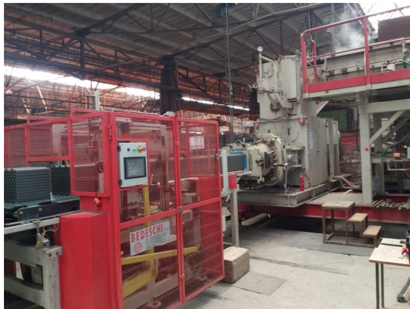
Obrázek 16 Vytváření výlisků lisem Bedeschi 650 (interní zdroje společnosti)
