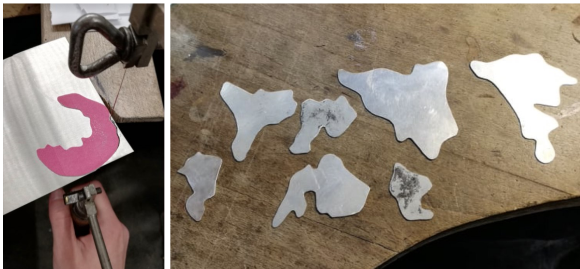
Obr. 42 Příprava základních tvarů dle šablon do stříbrného plechu, (zdroj: vlastní)
