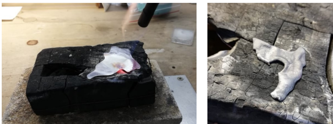
Obr. 43 Šmelcování a příklad zdeformovaného materiálu, (zdroj: vlastní)
