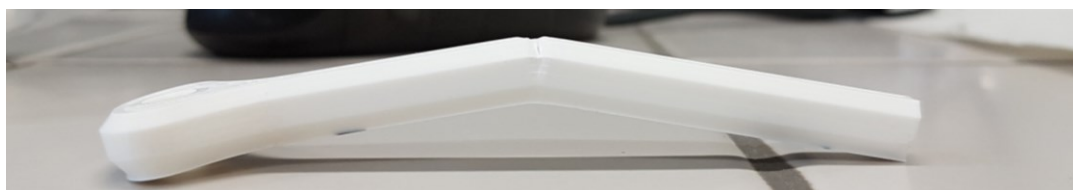
Obrázek 22 Zkušební tělísko z materiálu Tough PLA po zkoušce
