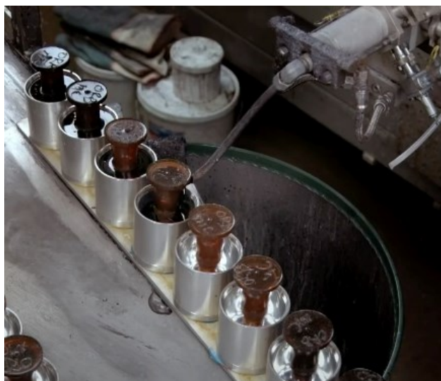
Obrázek 24 Odlévání skateboardových kol do statické formy v továrně Bones [10]
