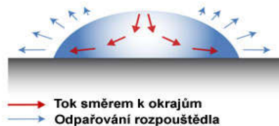
Obrázek 11 Princip vzniku prstencového efektu. K odpařování dochází především na okrajích. To vytváří tok kapaliny směrem od středu k okraji.[5]
