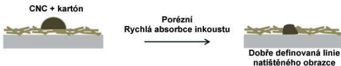
Obrázek 15 Řez natištěnou kapku a smáčení povrchu kartónu ošetřeného vrstvou CNC.[19]
