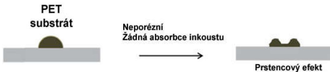
Obrázek 13 Smáčivost inkoustu na PET a řez natištěné kapky. Vznik prstencového efektu.[19]
