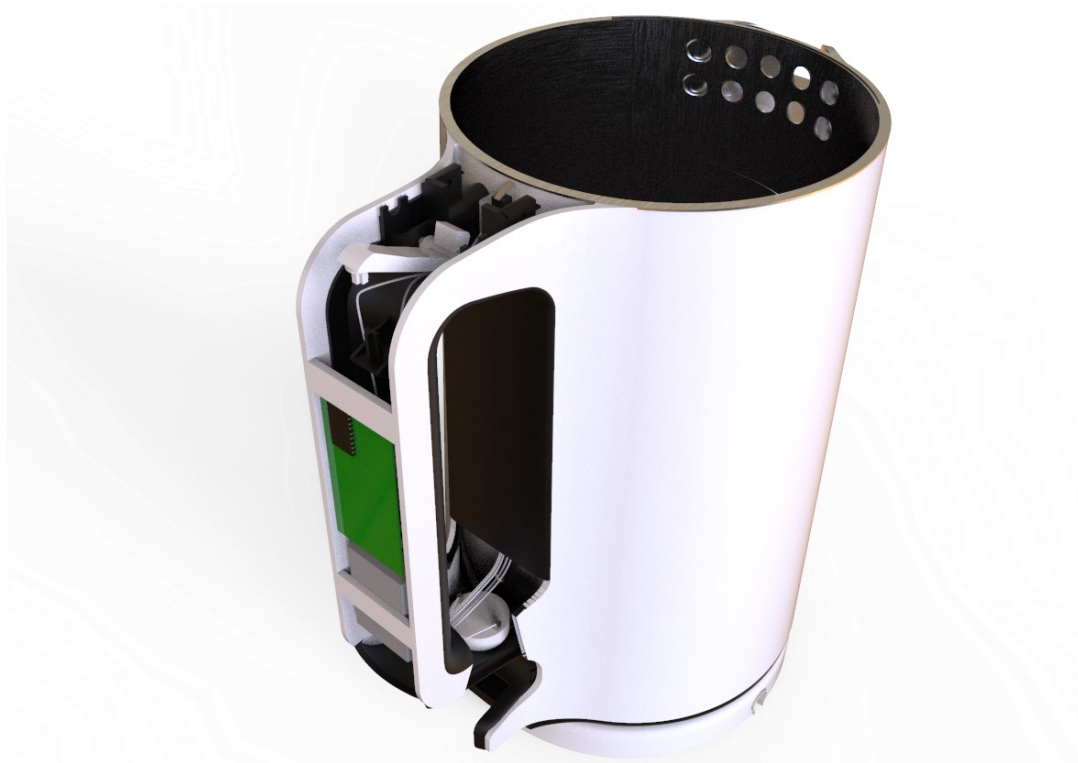
Obrázek 37 Ilustrativní znázornění umístění elektronických komponentů zvukového hlášení hladiny, včetně baterie, bzučáku, desky s čipem a vypínače umístěného při okraji tak, aby byl stlačen při zavření konvice.
