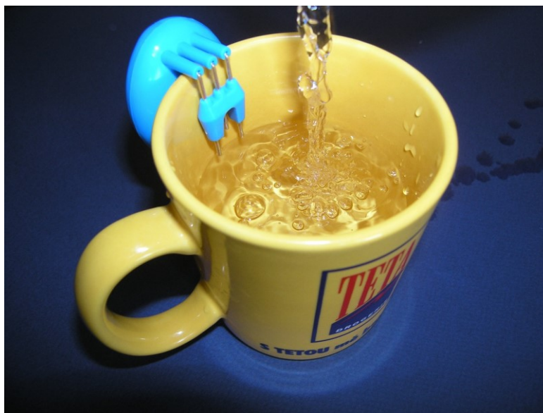
Obrázek 2 Indikátor hladiny, takzvaná „Hladinka“
