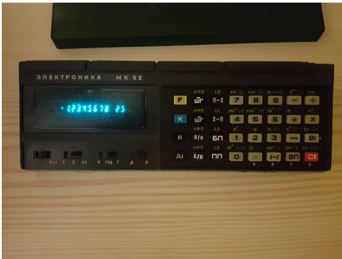
Obr. 6: Kalkulačka Elektronika MK 52 - povšimněte si absence klávesy '='
