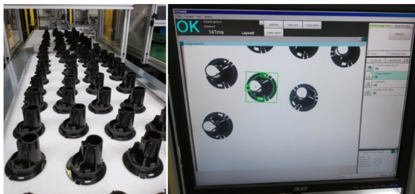
Obrázek 19 Výlisky „P20011“ na posuvném páse a snímek navádění robota na kusy (vlastní zpracování)
