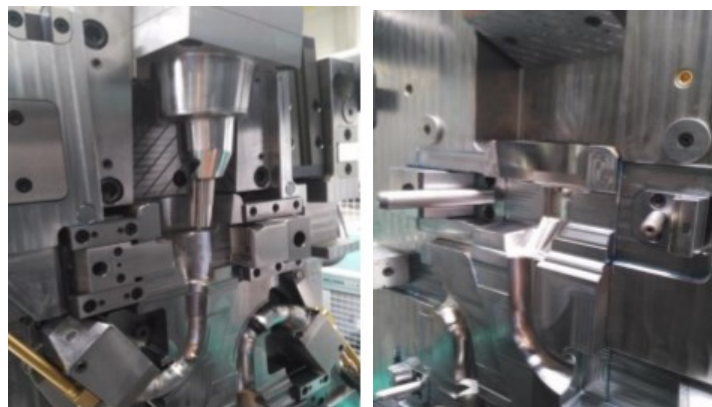
Obrázek 12 Vstřikovací a pohyblivá část vstřikovací formy – P20011 (vlastní zpracování)
