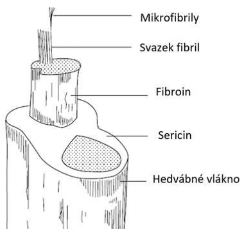
Obr. 1 Struktura hedvábného vlákna [1]
