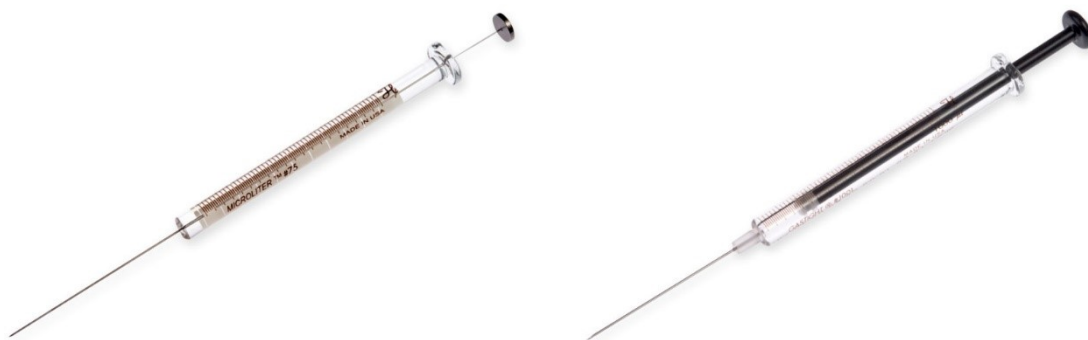
Obrázek 2: Dávkovací stříkačka pro kapalný vzorek (vlevo) a pro headspace techniku (vpravo) [65; 66]
