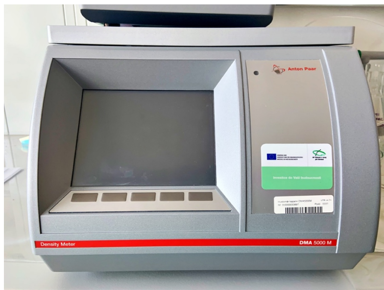
Obr. 10. Digitální hustoměr Anton Paar DMA 5000 M
