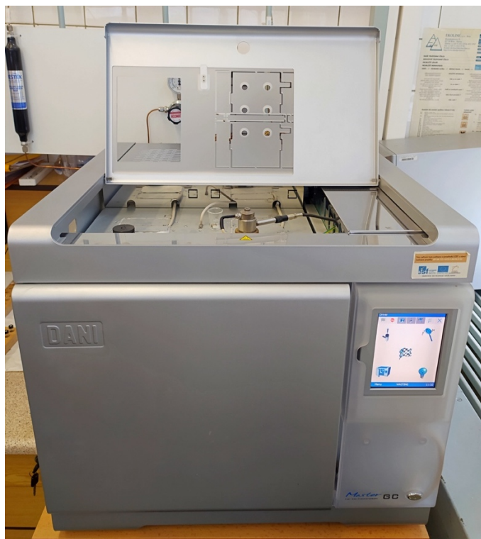
Obr. 9. Plynový chromatograf, DANI Master GC Fast Gas Chromatograph
